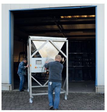
Leer kann das Silo mit Hilfe der Schwerlastrollen leicht in der Produktionshalle bewegt werden
